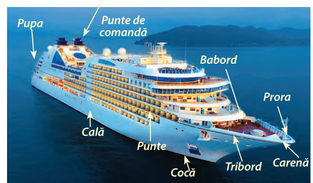
Fig. 28. Părțile componente ale unei nave
