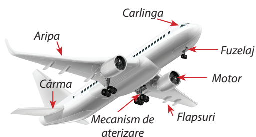
Fig. 19. Părțile componente ale avionului
